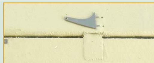
**45** Из толстой стальной заготовки, которую вы получили в 14-й посылке, извлеките три качалки элерона. Просверлите в нервюрах элерона, примыкающих с внешней стороны к петлям навески, по две маленькие дырочки и вклейте в них качалки. Они должны стоять строго перпендикулярно поверхности крыла.
