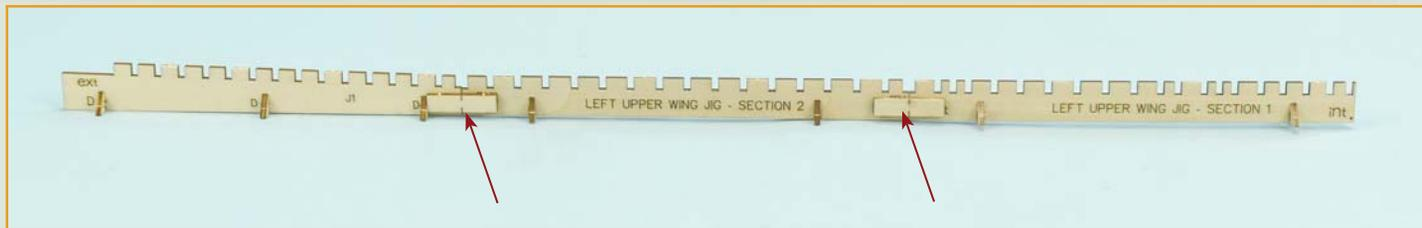
**11** Возьмите сборочные стапели, которые вы ранее использовали при сборке 1-й и 2-й секций верхней левой плоскости. Склейте их встык друг с другом и со стапелем, на котором вы собирали 3-ю секцию. Укрепите соединения прямоугольными кусочками фанеры, вырезанными из пластины-заготовки. У вас должен получиться стапель на всю длину плоскости, как на снимке.
