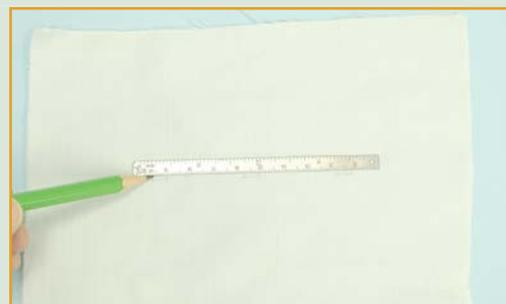
**29** Возьмите кусок обшивочной ткани, достаточно большой, чтобы покрыть элерон с обеих сторон. Положите на него каркас элерона и карандашом отметьте три прямоугольника под петли.
