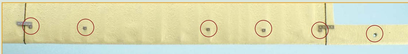
**44** Извлеките из пластины-заготовки 6 деталей С (направляющие тяг элеронов), согните их под прямым углом и приклейте сверху к крылу в местах, показанных на снимках. Отверстия в направляющих должны быть направлены вдоль размаха и находиться строго напротив друг друга.
