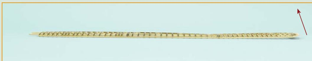
**16** После высыхания клея осторожно снимите готовую плоскость со стапелей. Вы можете убедиться, что третья секция имеет небольшой угол возвышения и очень незначительный угол стреловидности относительно первых двух секций.
