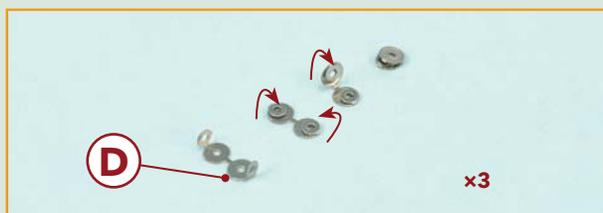
**46, 47** Возьмите три стальные детали D (направляющие ролики), согните их, как показано на верхнем снимке, а затем приклейте к крылу в тех местах, которые помечены на правом снимке. Ролики должны находиться на одном уровне с качалками.
