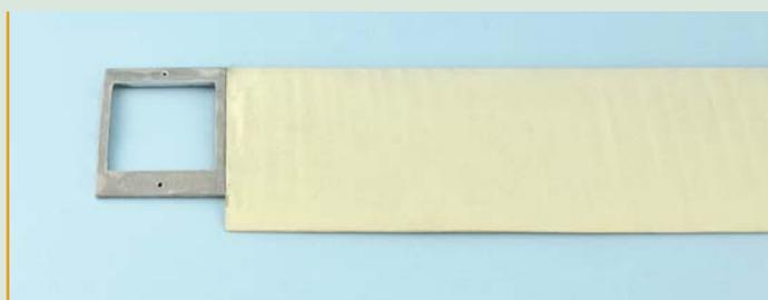
**37** Обклейте центроплан со всех сторон обшивочной тканью. Затем срежьте излишки ткани и зашлифуйте места обрезки.
