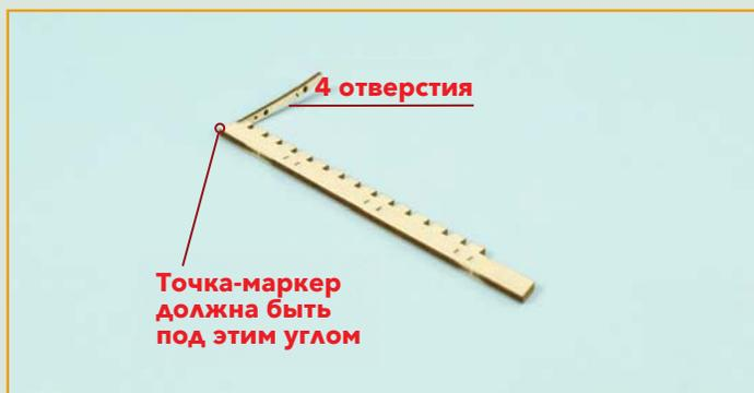
**2** Вначале приклейте хвостовик концевой нервюры с четырьмя отверстиями к задней кромке UWL3, используя для выравнивания треугольный шаблон T1.
