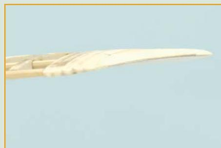
**8** Обработайте законцовку наждачной бумагой, чтобы придать ей плавную, закругленную форму, как показано на снимках.
