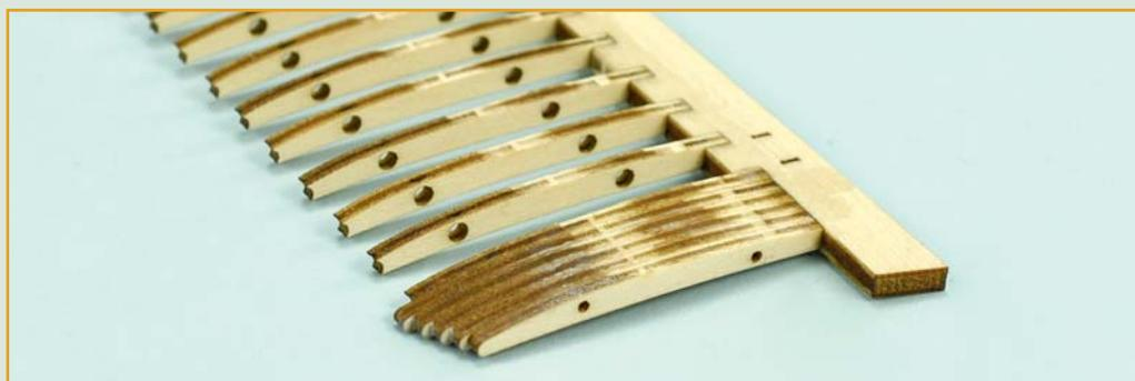
**5** Приклейте собранную законцовку к задней кромке и концевой нервюре, как показано на снимках. После этого вытащите стержни из законцовки.
